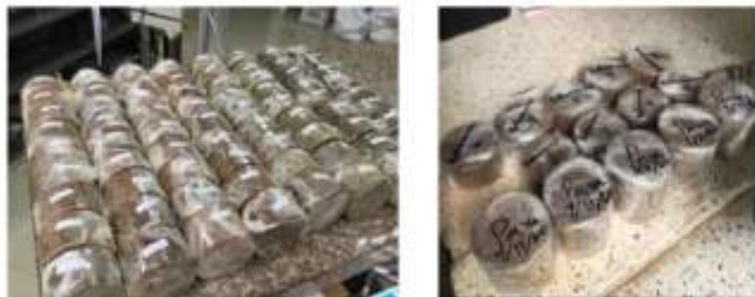
รูปที่ 5 แสดงการเตรียมก้อนตัวอย่างเพื่อนำมาทดสอบคุณสมบัติเชิงวิศวกรรมในห้องปฏิบัติการ
