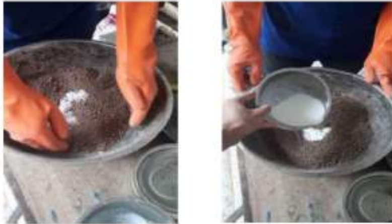
รูปที่ 4 แสดงการผสมน้ำยางพาราผสมสารผสมเพิ่มกับดินซีเมนต์
