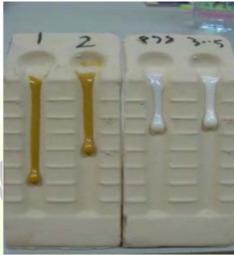
ภาพที่ 4 แผ่นทดสอบการไหลตัวของเคลือบตามความลาดเอียง
