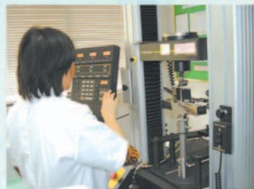
ASTM ของสหรัฐอเมริกา, BS ของอังกฤษ, JIS ของญี่ปุ่น โดยให้บริการได้อย่างครบถ้วน ทุกรายการที่กำหนด เช่นความแข็ง ความหนาแน่น อัตราการไหลเมื่อหลอมเหลว จุดหลอมเหลว จุดเปลี่ยนสถานะคล้ายแก้ว ความทนแรงกระแทก ความทนความร้อน/ความเย็น ชนิดและองค์ประกอบ ความปลอดภัย ความต้านแรงดึง ความยืด ความทานทานต่อกรด ด่าง และสารเคมี
