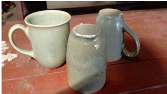
ตำหนักเคลือบไหลเย็น เนื่องจากอุณหภูมิการเผาเกิน
