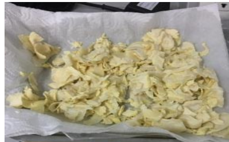
ภาพที่ 5 การทดลองหาการสูญเสียน้ำหลังการละลายน้ำแข็ง (Driploss) ของเนื้อทุเรียนดิบหั่นชิ้นแช่เยือกแข็ง
