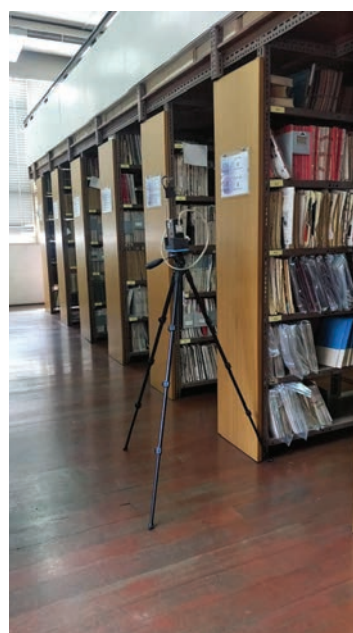
การตรวจวัดคุณภาพอากาศ ภายในอาคารอนุรักษ
