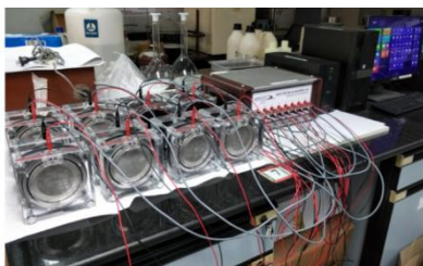
การทดสอบการซึมผ่านคลอไรด์ตามมาตรฐาน ASTM C1202 - 19
