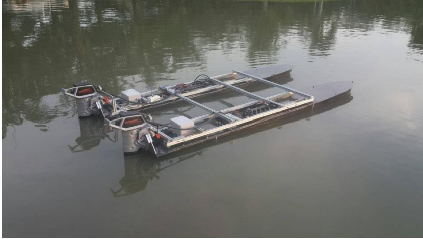
ภาพที่ 2 เรือลาดตระเวนแบบสองที่นั่งควบคุมระยะไกลเพื่อใช้ช่วยตรวจจับวัตถุต้องสงสัยด้วยภาพ
