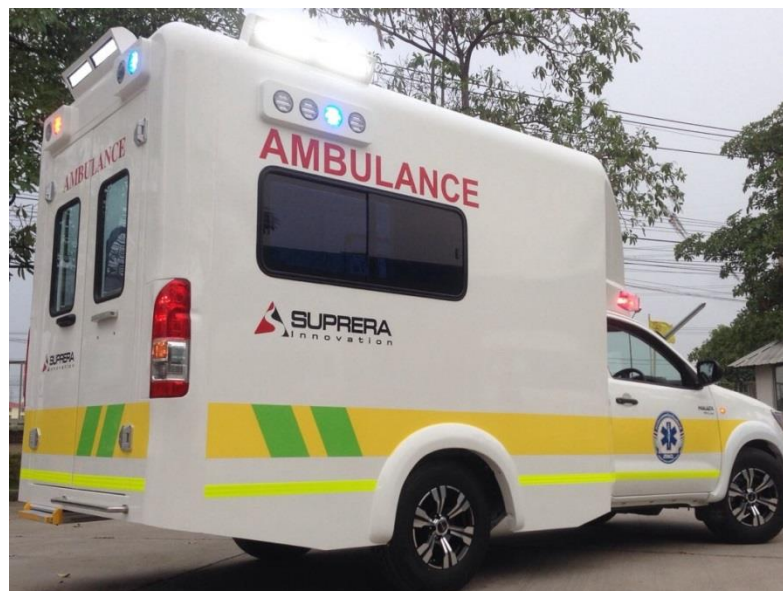
ภาพที่ 1 ผนังตัวถังรถพยาบาลที่ได้รับการถ่ายทอดเทคโนโลยีผลงานวิจัยและพัฒนานวัตกรรมวัสดุไฟเบอร์คอมโพสิตด้วยอนุภาคนาโน
