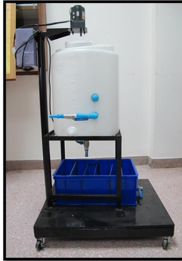
รูป ระบบบำบัดน้ำเสียจากกระบวนการย้อมสี
