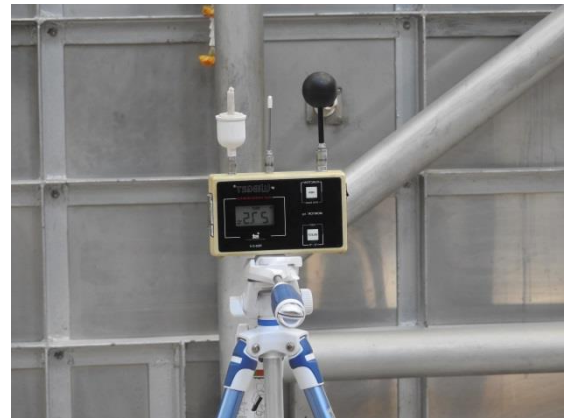
รูปที่ ๒ การตรวจวัดความร้อนหน้าตู้อบ
