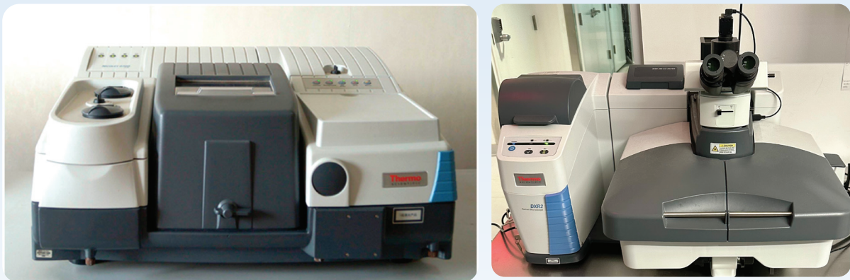
รูปที่ 3 เครื่องมือวิเคราะห์ FTIR Spectrometer และ Raman Spectroscopy
