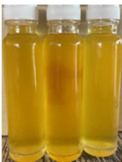
รูปที่ 2 แสดงผลการทดสอบโคลิฟอร์มแบคทีเรียของน้ำหลังผ่านเครื่องกรองน้ำ วศ. ที่ติดตั้งระบบฆ่าเชื้อด้วยรังสีอัลตราไวโอเลต (สีส้มแดงให้ผลลบคือ ไม่พบเชื้อ และสีเหลืองให้ผลบวกคือพบเชื้อ)
