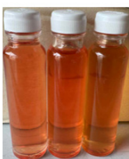
รูปที่ 2 แสดงผลการทดสอบโคลิฟอร์มแบคทีเรียของน้ำหลังผ่านเครื่องกรองน้ำ วศ. ที่ติดตั้งระบบฆ่าเชื้อด้วยรังสีอัลตราไวโอเลต (สีส้มแดงให้ผลลบคือ ไม่พบเชื้อ และสีเหลืองให้ผลบวกคือพบเชื้อ)
