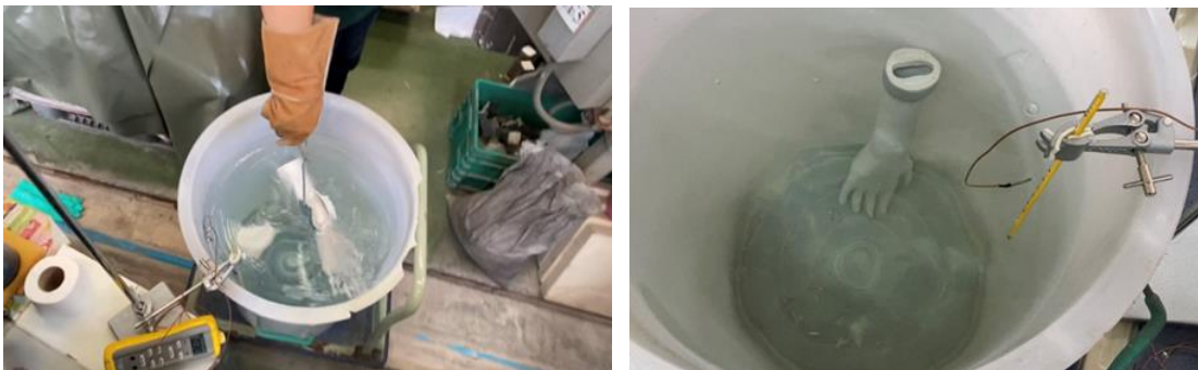
การทดสอบความทนทานของผลิตภัณฑ์ต่อการเปลี่ยนแปลงอุณหภูมิแบบฉับพลัน)
