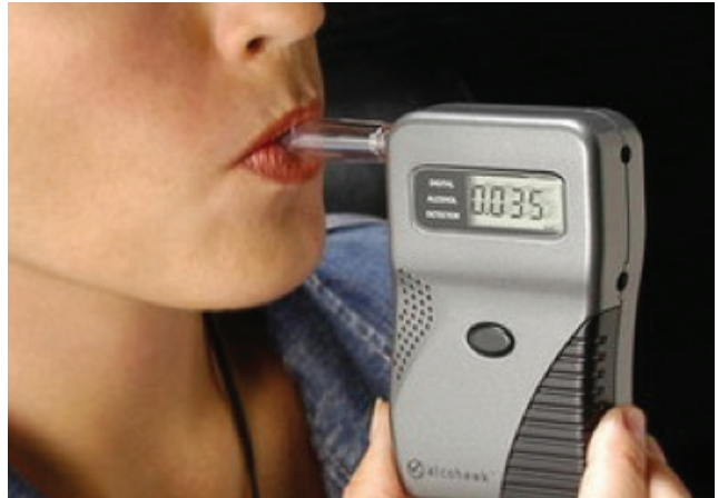
รูปที่ 1 เครื่อง ALCO-SENSOR V สำหรับวัดปริมาณแอลกอฮอล์ในเลือดโดยวิธีเป่าลมหายใจ
