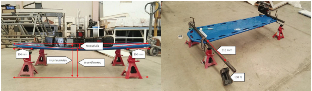
ภาพการทดสอบการรับน้ำหนักของแผ่นกระดานเคลื่อนย้ายผู้ป่วย และการทดสอบความทนต่อการบิดตัว
