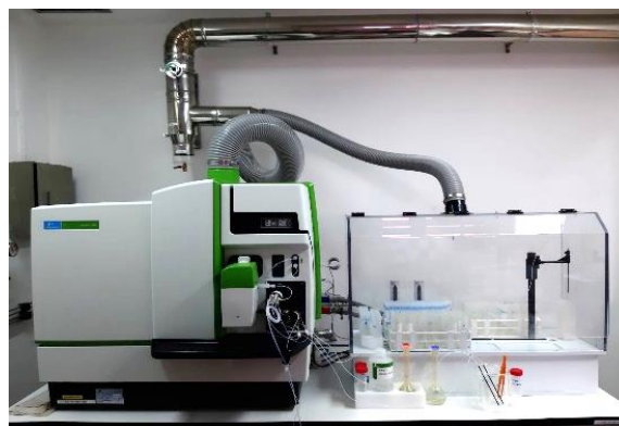
รูปที่ 2 เครื่อง ICP-OES วิเคราะห์โลหะหนักในเกลือ
